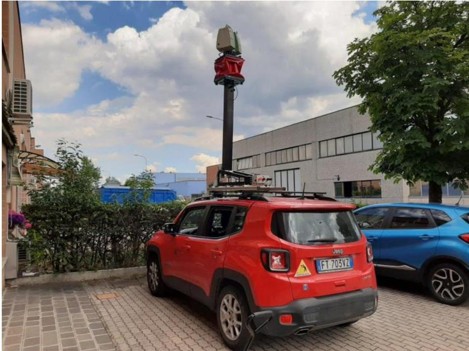
Sistema di sollevamento per qualsiasi marca e tipo di laser scanner terrestre.
