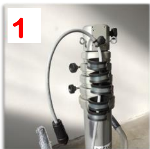
1 Inserire dall'alto il cavo di collegamento D) all'interno dei passa cavi
