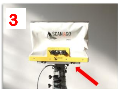
3 Posizionare il livellatore automatico LPE16 utilizzando i bulloni guida della parte inferiore
