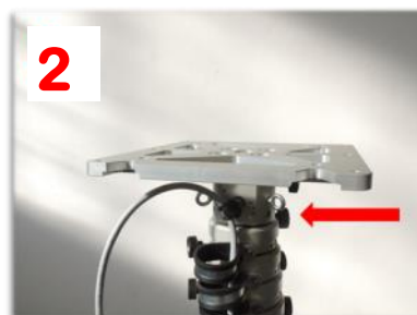
2 Inserire la piastra sulla testa della struttura e serrare la vite di blocco
